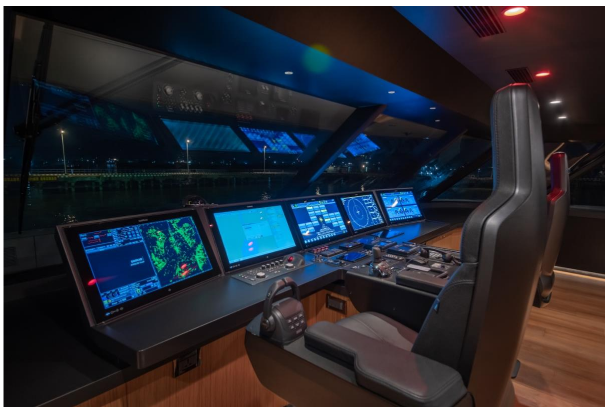
Les équipements d'alarme et de surveillance installés à bord du Spacecat ©Silver Yachts
